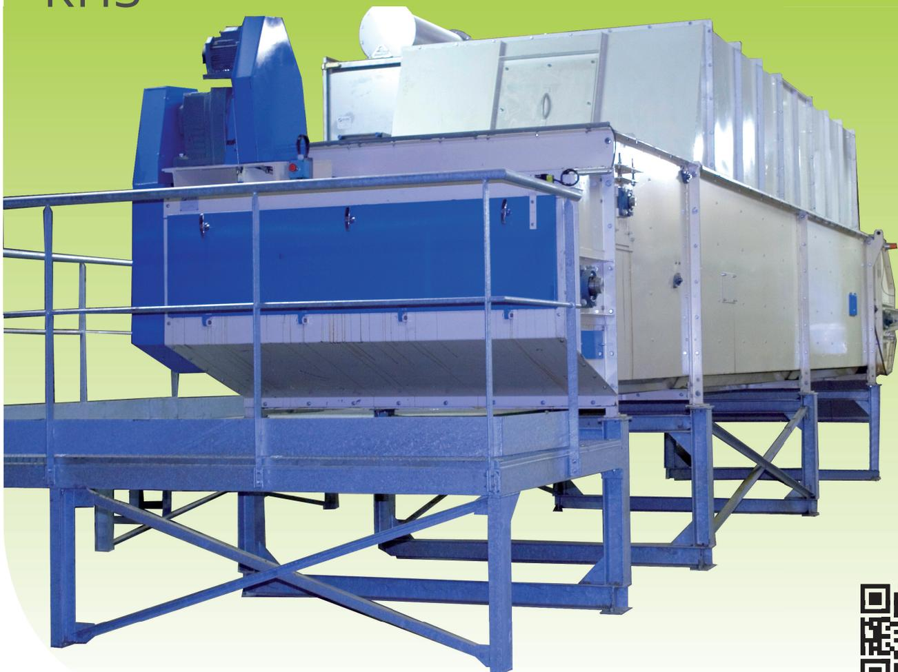
Le refroidisseur a pour but de ramener la température et l'humidité du produit à des valeurs proches de la température ambiante. Cette opération permet d'améliorer la durabilité et la conservation des granulés.
