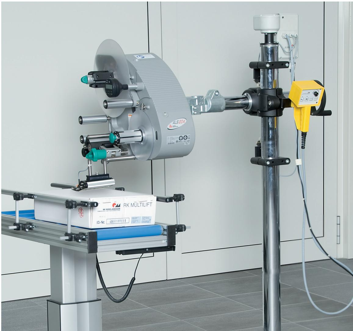
Positionnement d'un robot d'étiquetage à l'aide d'une unité linéaire tubulaire E croisée
