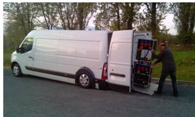
Le pivotement des roues et la compression de la suspension permettent un abaissement maximum.
