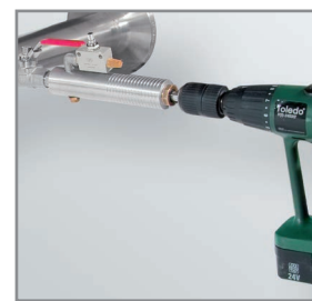
Perçage sous pression avec l'outil de perçage CS
