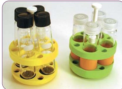
Utilisables dans les rotors SX4750 et SX4750A avec les canisters Aerosolve 359232. Le concept de porte-tubes ouvert permet une inspection rapide pour détecter la présence éventuelle de tubes brisés ou présentant des fuites.
