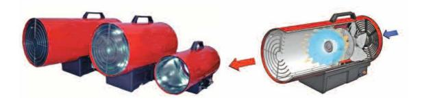
Les générateurs portables KID à combustion directe de gaz assurent un chauffage ponctuel économique dans diverses applications. Ils conviennent pour le chauffage de petits à moyens espaces et d'ateliers bien ventilés, ainsi que pour le séchage dans le secteur du bâtiment. Kid peut être commandé en version manuelle (M) ou automatique (A).
