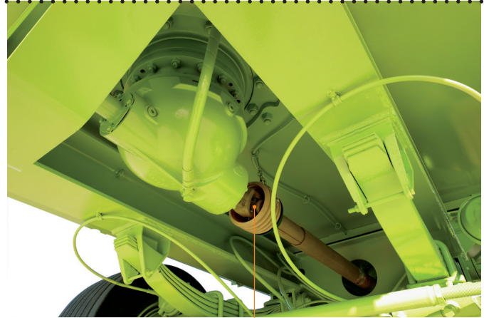
Überdimensioniertes Planetengetriebe geeignet für besonders schwere Einsatzbedürfnisse Réducteurs pour utilisations particuliè- rement lourdes montés d'origine Standaard verdragingskast voor zware omstandigheden
