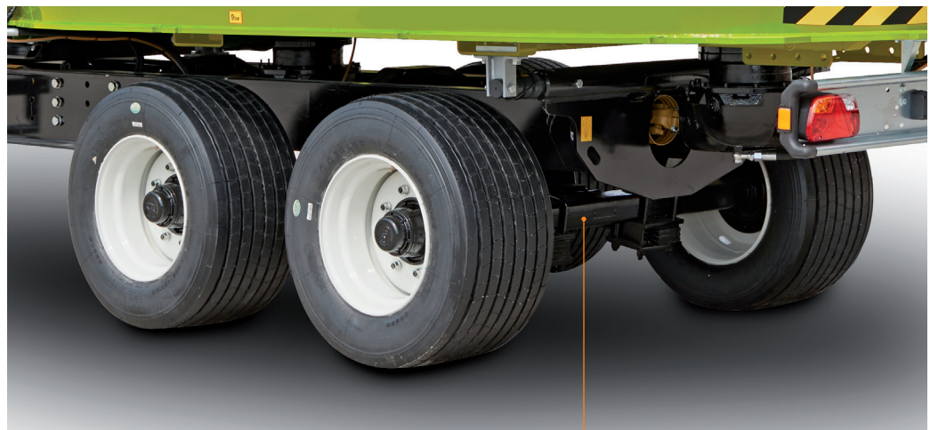
Neue Bogieachse, auch mit Nachlaufenkung erhältlich, bei Dunker T25 und T2L Nouveau bogie, disponible aussi en version autodirectrice, sur les dunker T25 comme les T2L Nieuwe bogie, verkrijgbaar ook in zelfsturende versie, zowel op dunker T25 als op T2L
