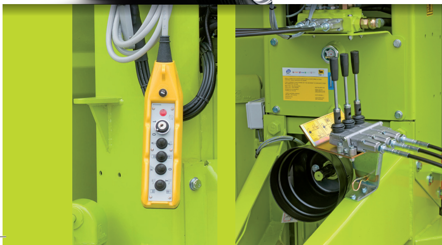
Zwei Bedienungsmöglichkeiten: elektrische Fernbedienung (Links) oder mechanische Bedienung über Bowdenzüge (Rechts)
