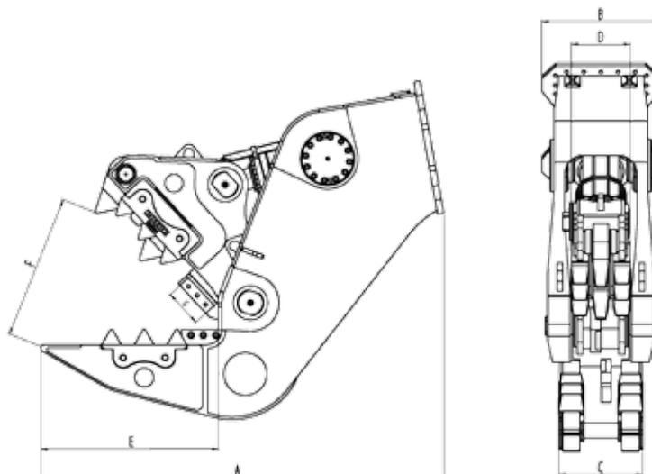
En option, le Broyeur rigide Rotar possède des couteaux interchangeables au fond des mâchoires du broyeur. Ces derniers permettent de couper en morceaux les armatures du béton.
