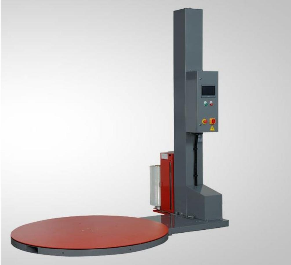
Emballeuse semi-automatique de dernière génération pour l'emballage de charges palettisées, équipée de pré-étirage motorisé pour garantir une consommation minimale de film. Les seules étapes manuelles sont la découpe du film et sa fixation sur la palette. Le reste des opérations est entièrement automatique et facilement programmable grâce à l'écran tactile avec un menu graphique et intuitif.
