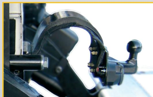
Console attache-remorque, montage rapide et facile, peut être installée après le montage du hayon.
