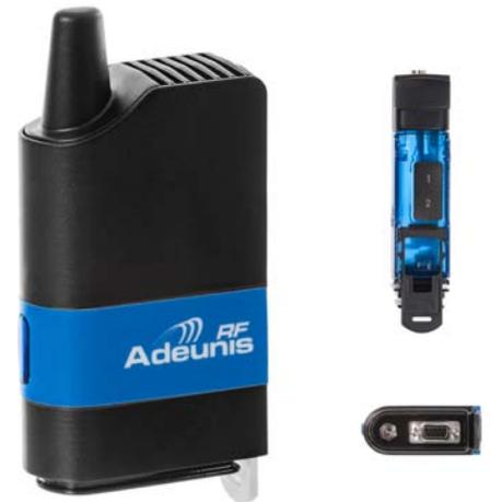
Les **ARF868** sont des modems radio de nouvelle génération qui permettent la transmission de données sans fil bidirectionnelle Half Duplex jusqu'à 20km.
