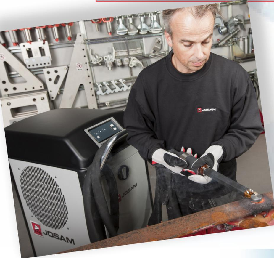
**Le JCI 14811 convient au léger redressement et desserrage des pièces de machines plus grossières...**
