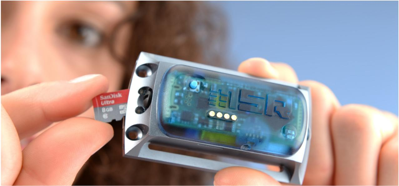
L'enregistreur équipé d'un capteur d'accélération triaxial à haute résolution ( $\pm 15$  G resp.  $\pm 200$  G) vous fournit des données précieuses quant aux chocs et vibrations.
