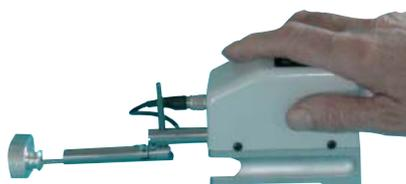
Mesure de rugosité d'un alésage
