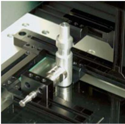
Le système-DF est un nouveau système de fixation développé et produit par Schut et conçu pour la construction de montage de fixation en 3D, particulièrement pour les mesures optiques.
