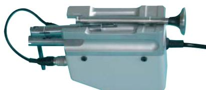
Mesure d'une pièce posée sur l'unité, palpeur à 180°
