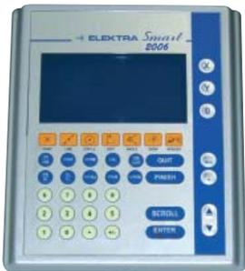
Nombreuses fonctions de mesures géométriques : point, droite, rayon, cercle, angle, distance, etc.
