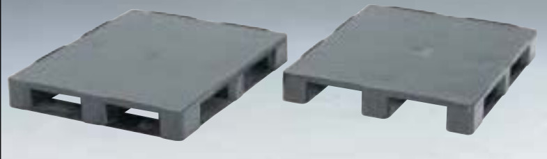
Palettes hygiéniques norme ISO disponibles avec 3 patins et avec un patin périphérique. Le renforcement facultatif par des tubes en acier augmente la charge, comme pour les palettes Euro.
