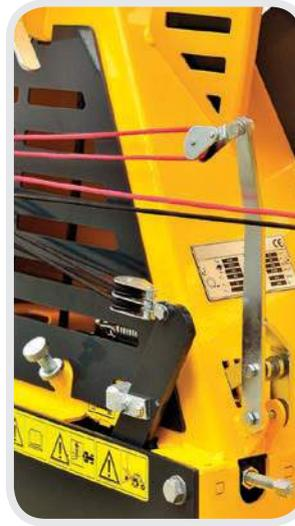
1. Appareil automatique d'activation de la traction ou du frein caché dans le boîtier du treuil et ainsi protégé des intempéries.
