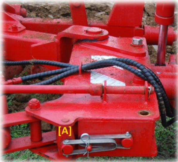
La Charrue est équipée d'un vérin de retournement et d'un vérin de réalignement qui permet le recentrage de celle-ci à chaque retournement. **Le système de recentrage est automatique** avec une butée mécanique qui fait office de mémoire [A]. Il soulage le relevage de votre tracteur et facilite le retournement. Le vérin permet aussi de positionner la charrue dans l'alignement du sens d'avancement.
