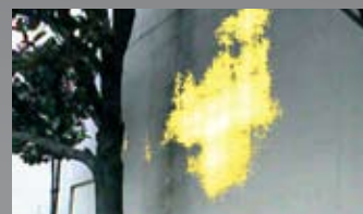
Image mixte, obtenue par la fonction Fusion, révélant l'eau infiltrée dans le mur et la moisissure.
