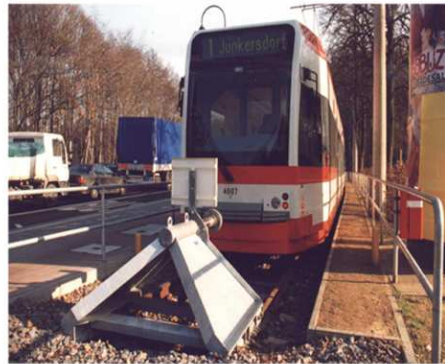
Heurtoirs de freinage avec des amortisseurs pour le transport urbain.
