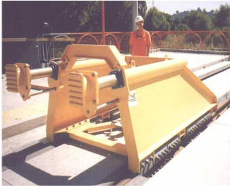
Heurtoirs de freinage avec des amortisseurs pour le transport urbain.
