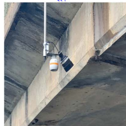
FarSight™ et Reflect™ montés sur le support dBA0008 pour une mesure aire-vitesse
