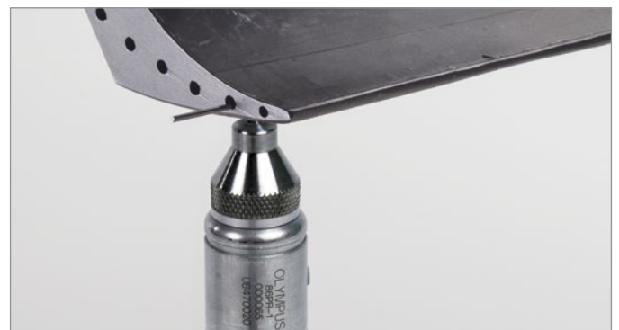
Mesure d'une aube de turbine à l'aide d'un fil
