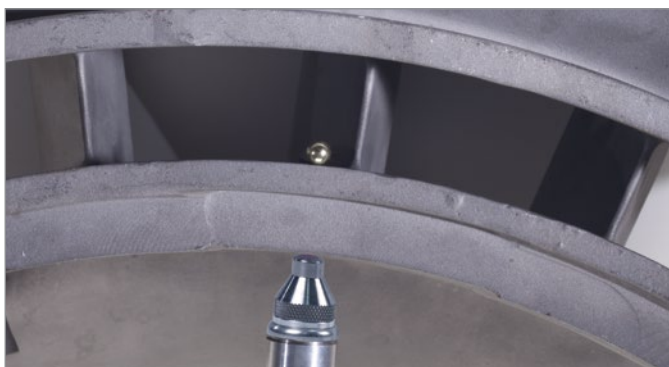
Mesure d'une pièce coulée de 24,1 mm de l'industrie aérospatiale
