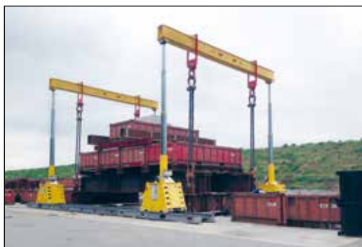
◀ Portique SL-400 pendant un test de charge.
