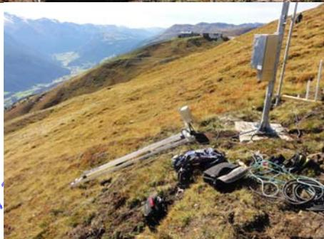
Le système SMA combine les techniques de mesure des capteurs SPA (analyseur de pack) & SSG (pèse neige). Le système est installé à l'horizontale au niveau du sol, il analyse en particulier la couche de fond du manteau neigeux, car c'est la couche la plus intéressante en regard du départ d'eau. Une élévation du contenu en eau liquide signale le début de la fonte. Une prolongation utile sur une station de mesure de la neige équipée du système SMA est le capteur de hauteur de neige USH-8.
