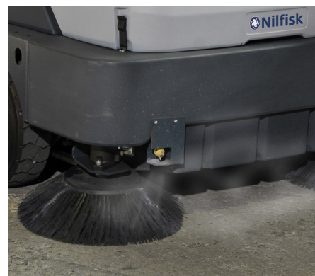
Le système DustGuard™ exclusif contrôle de manière efficace la poussière dans l'air en pulvérisant un fin brouillard d'eau sur les balais latéraux.
