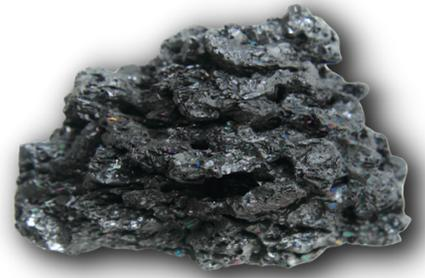
Le corindon brun est un oxyde d'aluminium cristallisé électro fondu, élaboré à partir de bauxite calcinée. Sa teneur élevée en bioxyde de titane lui confère une grande solidité.
