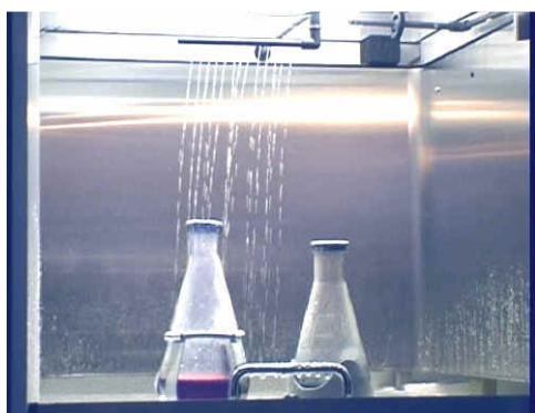
« sous l'averse » Test du joint d'étanchéité
