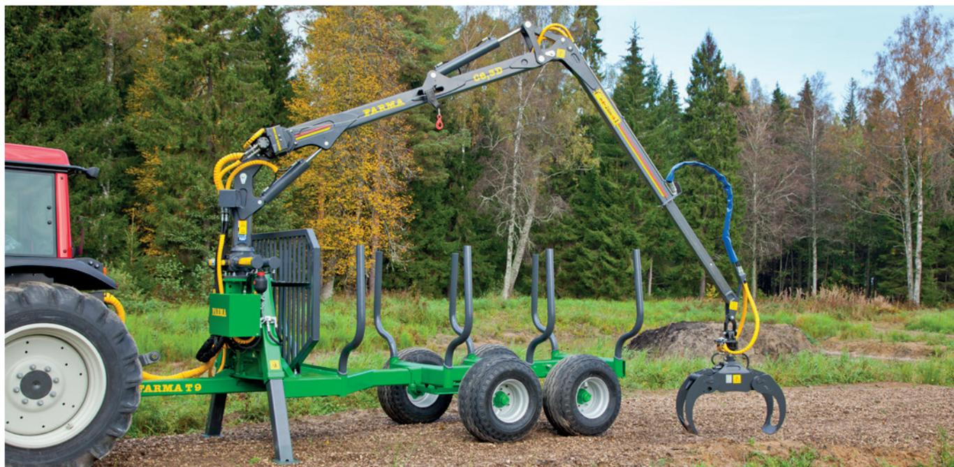
**NOUVEAU !** FARMA propose désormais dans sa gamme deux nouveaux modèles de treuils à radio-commande. La radiocommande facilite le travail sur la benne, mais par dessus tout, elle le rend plus sûr. Le treuil est disponible en deux versions. Une version plus petite pour les grues de 3,8 m avec câble de 5 mm et d'une longueur de 30 m. Une version pour les grues de 4,6 m et plus avec câble de 6 mm d'une longueur de 35 m comme sur le produit standard.
