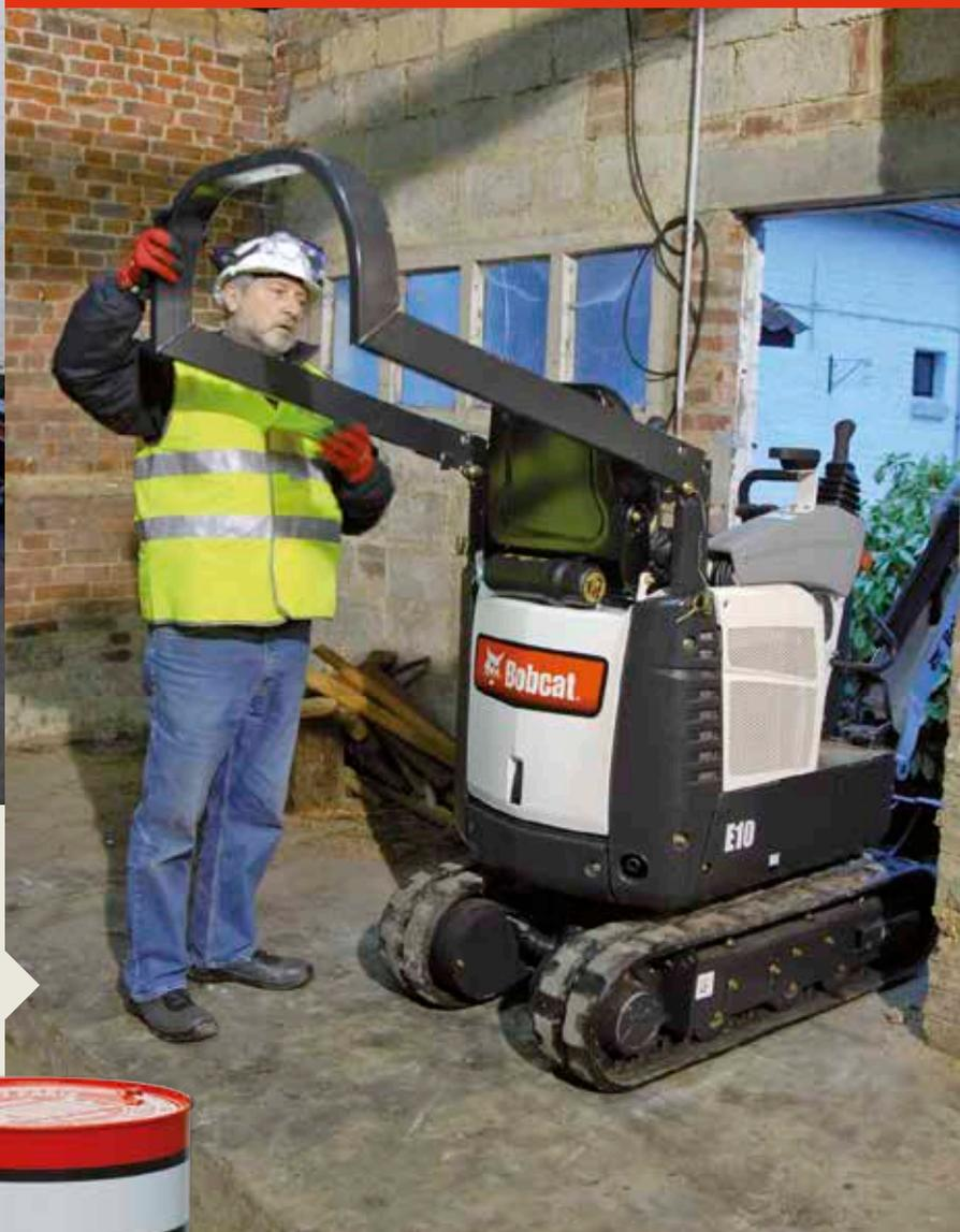
Les deux modèles sont équipés d'une structure TOPS repliable.
