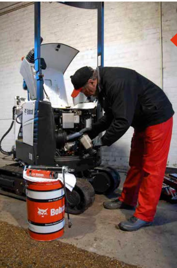
Grâce à l'accès facilité au moteur et aux systèmes hydrauliques, l'entretien est simple et rapide.
