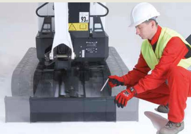
L'E08 et l'E10 sont toutes deux dotées de série d'un châssis inférieur à voie variable et d'une lame rétractable. Par conséquent, nul besoin de déposer et d'installer des rallonges de lame.
