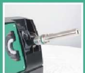
La pointe est facilement aplatie en réglant l'angle d'affûtage sur 90°
