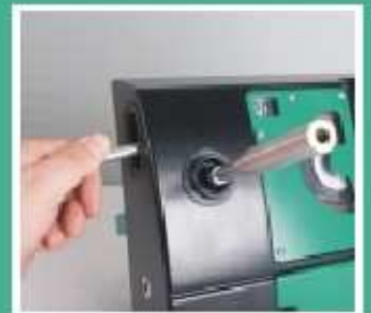
TIP-TRIMMER est capable de couper et d'affûter des électrodes d'une dimension de 10 mm
