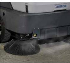
Le système DustGuard™ exclusif contrôle de manière efficace la poussière dans l'air en pulvérisant un fin brouillard d'eau sur les balais latéraux.
