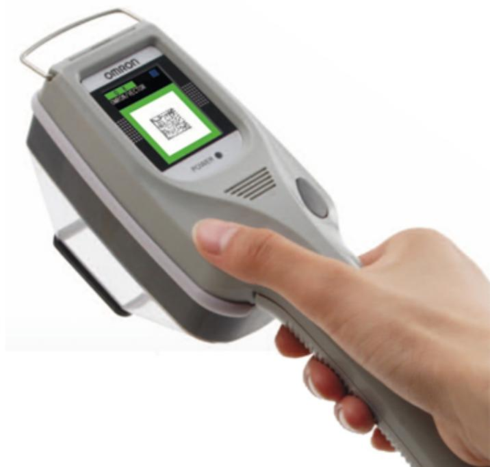
Le V400-H est un lecteur de code 2D portable conçu pour vous offrir une lecture fiable et un grand confort d'utilisation. L'écran LCD intégré n'affiche pas seulement une image en temps réel de votre objet pour simplifier le ciblage, il fournit également un retour instantané des informations décodées.
