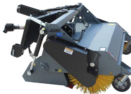
Balayeuse polyvalente conçue pour être spécifiquement appliquée aux tracteurs. Entraînement par cardan, avec godet de ramassage, brosses en polypropylène, 2 roues de support pivotantes, ouverture hydraulique du godet. Produit avec des largeurs de 130 à 280 cm d'utile. Possibilité de relever le godet pour le transformer en balayeuse orientable pour balayer la neige ou simplement pour balayer le bord de la route.
