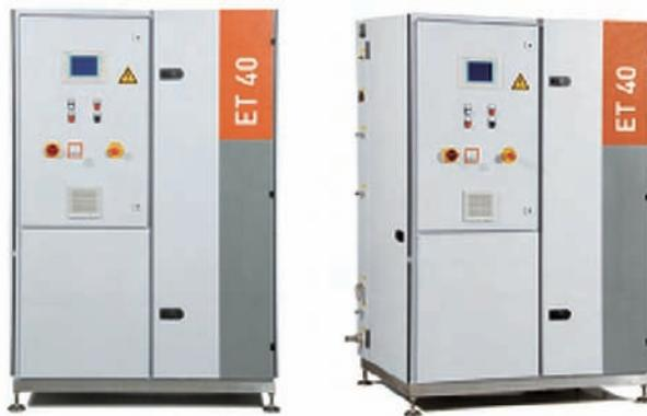
La compresión de emisión de vapores supone el reempleo constante de la energía contenida en el vapor. Gracias al intercambiador de calor de evaporación de fluido forzado y el consecuente empleo del calor del destilado es posible un consumo de energía bajo, de 35 vatios/litro. La regulación de la compresión y un tratamiento posterior del destilado integrado por medio de un coalescente tienen por resultado las mejores calidades del destilado.
