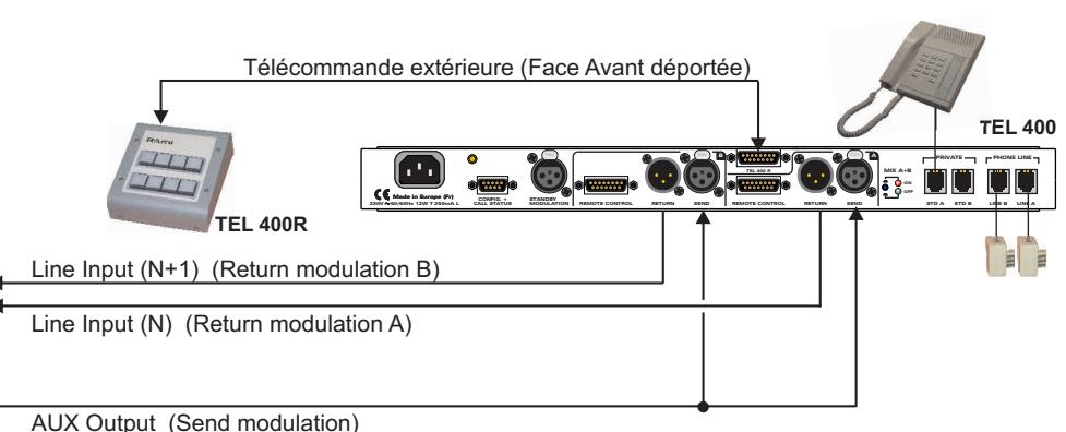
Remarque : si la console dispose de 2 sorties auxiliaires, les modulations d'envoi des inserts A et B peuvent être différencierées.
