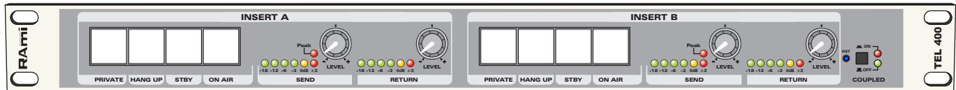
**□ Touche “ON AIR” :** permet de passer le correspondant à l'antenne. Lors de l'appui de cette touche, une séquence d'apprentissage (associée à l'annulation d'écho) est transmise, le clavier est inhibé pendant 2 secondes. Si à l'antenne la qualité audio du retour correspondant se dégrade, l'appui sur la touche “ON AIR” permet de relancer la séquence d'apprentissage pour optimiser la liaison téléphonique.
