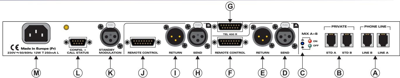
**A)** Embases RJ11 pour la connexion avec le réseau téléphonique.
