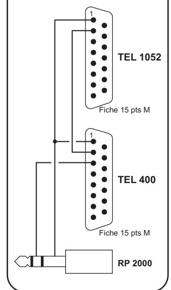
Câblage avec une console ne disposant pas de voie dédiée à la gestion d'insert.
