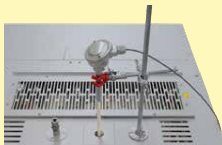
Passage des thermocouples dans la voûte avec pied
