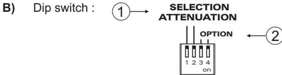
① ► Réglage de l'atténuation de l'entrée AUX en présence d'entrée ORDRE (Variable de -6 dB à -24 dB). A chaque "dip" correspond une valeur en dB, active en position basse.
