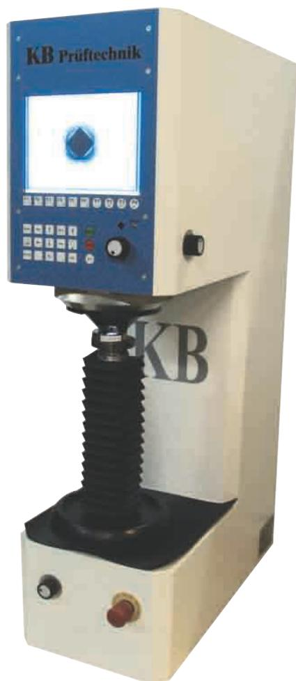
La gamme des machines de dureté universelles KB est conçue pour réaliser en automatique les essais de dureté normalisés Vickers, Brinell, Rockwell et Rockwell superficiel. Les charges disponibles vont de 1 à 3000 KgF. Le contrôle d'application des charges est réalisé par capteurs de force.
