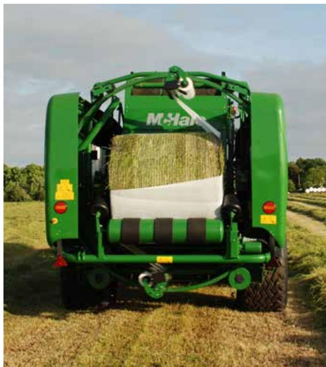
03 Au fur et à mesure que la balle se forme à l'intérieur de la chambre, le système de densité hydraulique prend le relais par rapport aux ressorts. Deux vérins hydrauliques contrôlent la tension sur la ou les courroie(s) de la chambre.
