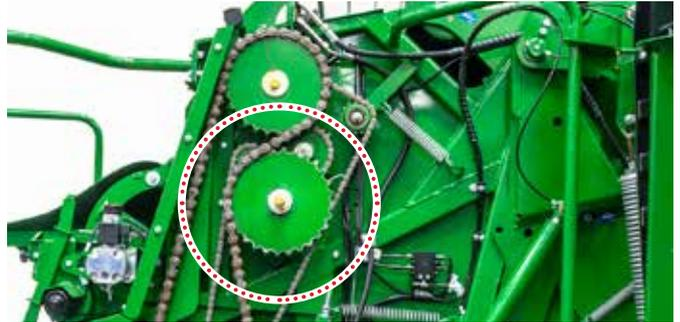
Système de verrouillage de la porte mécanique
