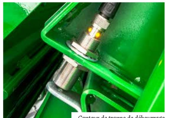
Capteur de trappe de débouillage
