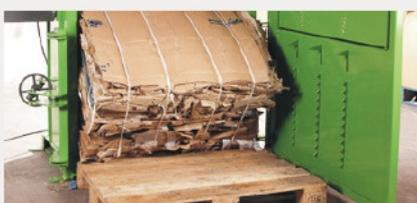
Haut ratio de compactage permettant de créer des balles optimales de 250 kg et plus
