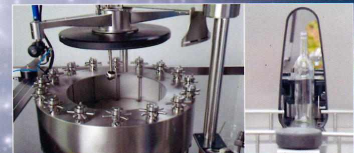
Cuve tireuse vue du haut
