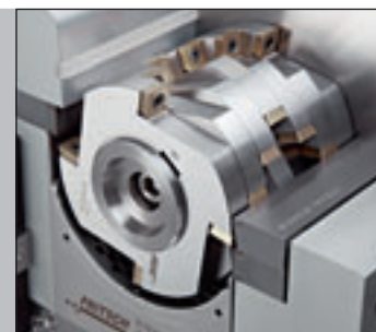
Différents rotors pour usage multifonctionnel, comme le rotor à fraise circulaire.
