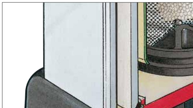
Colonne à deux chambres de dessiccation, en aluminium extrudé à haute résistance à la traction.
