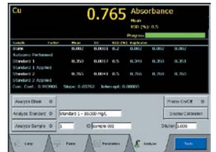
La page d'analyse des échantillons offre un moyen simple d'analyser manuellement des échantillons ou d'ajouter un passeur d'échantillons pour automatiser entièrement l'analyse.
