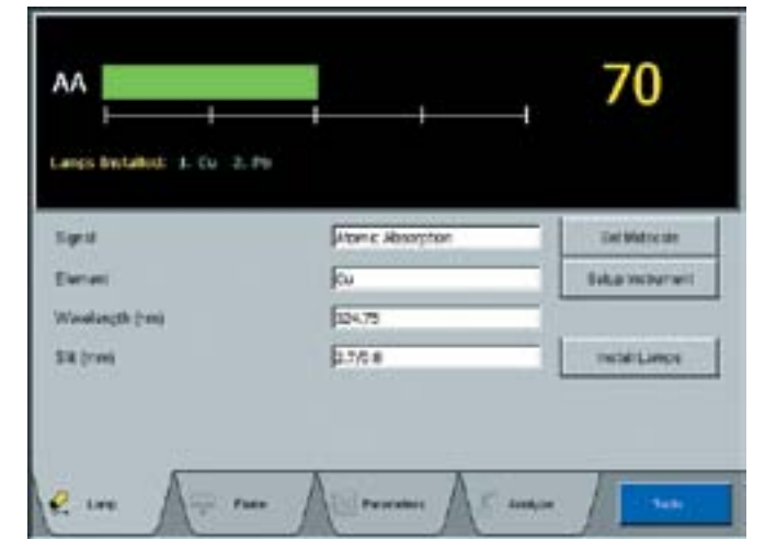
La page de configuration des lampes règle automatiquement l'instrument une fois le code de lampe Lumina entré.
