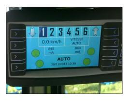
Ce système électronique situé dans la cabine permet de sélectionner automatiquement soit les couteaux, soit les pneumatiques.
