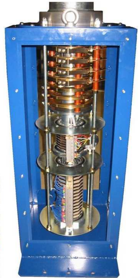
Puissance -Commande—Ethernet PONT TOURNANT NUCLEAIRE
