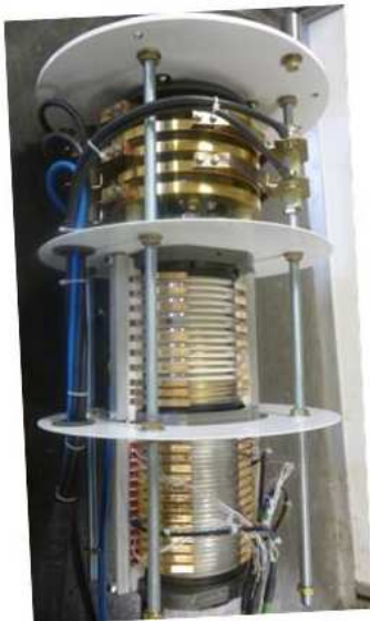
Puissance 40Kw, Commande 24V Ethernet 100Mb/s Passage creux Ø38mm RECHERCHE SCIENTIFIQUE
