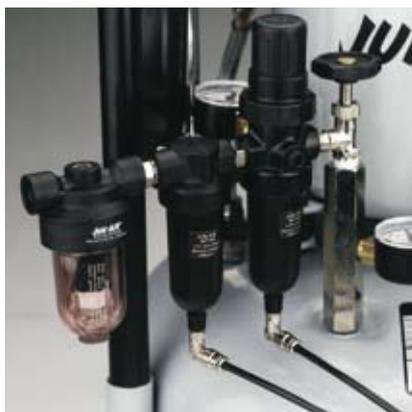
*Filtres montés sur un compresseur*
