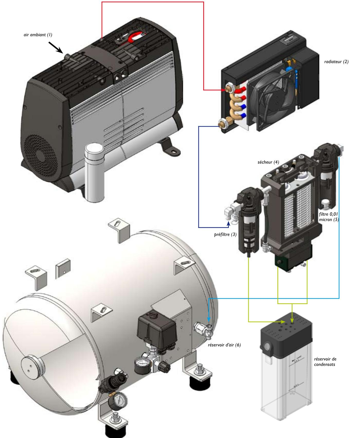
— Air chaud et humide — Air froid et humide — Air froid et sec — Eau
