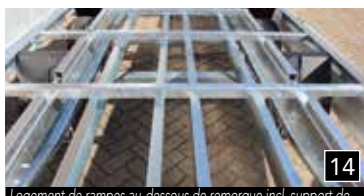
Logement de rampes au-dessous de remorque incl. support de plancher (standard à modèles)
