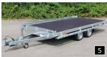
Sans ridelles, avec rambarde (Combi Protect Rail pivotante)
