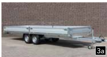
Modèles avec une longueur de ≥ 4.5 m. sont prévu d'un piquet centrale
