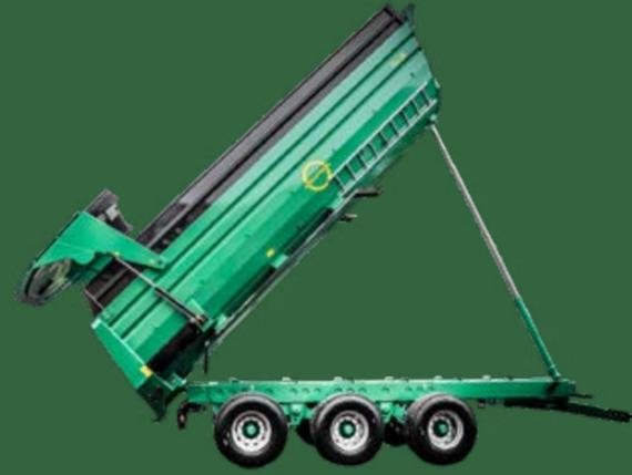
Caja basculante cilíndrica de gran resistencia, diseñada con gran cantidad de pliegues que consiguen una gran rigidez de la misma y a la vez que aligeran su peso. Conformación redondeada de la caja que disminuye considerablemente la adherencia de la carga: su contorno actúa como tobogán dirigiéndola al centro durante la descarga.
