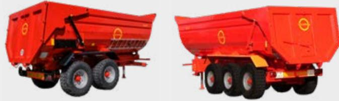
Cilindro hidráulico de 3 a 4 expansiones. El cilindro frontal consigue una mejor elevación de la caja basculante con mayor estabilidad que los cilindros tradicionales colocados por debajo, ya que al alzarla trabaja con el mínimo esfuerzo y el punto de amarre compensa más eficazmente el peso sobre el enganche del tractor.
