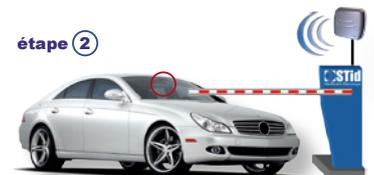
))) Transmission des données du tag au système de contrôle d'accès pour autoriser l'accès
