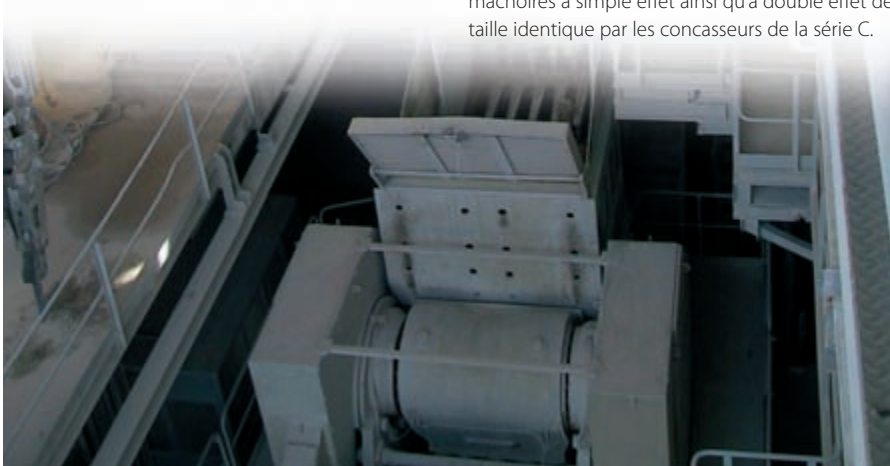
Un C200 remplaçant un concasseur à mâchoires à double effet. La capacité de l'installation a été augmentée sans nécessiter la modification des fondations.
